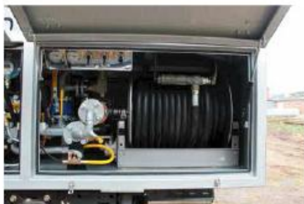
Барабан с пневмоприводом со шлангом L=50м и трубиной для заправки газгольдеров
