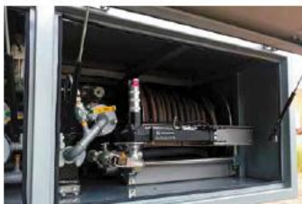
Барабан с электроуправлением со шлангом L=50м с GuideMaster
