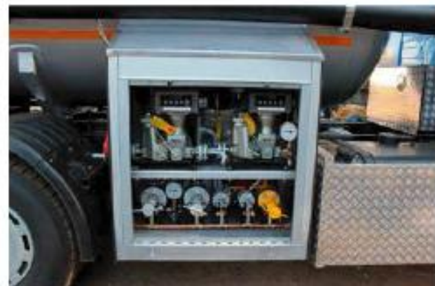
Параллельный слив двумя расходомерами LPM-102
